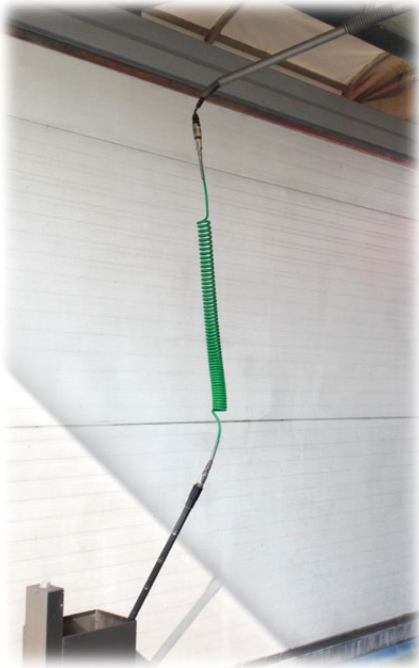
SPIRALE IN RILSAN mt. 7,5 PER SPAZZOLA RILSAN SPIRAL HOSE m. 7,5 FOR BRUSH
